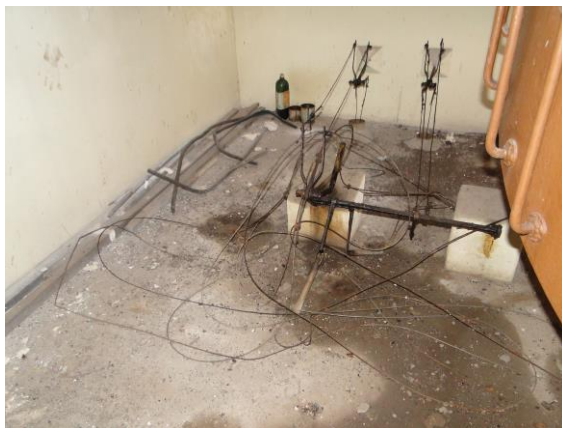
FOTO 147 DETALHE DOS CABOS DE AÇO, ENGRENAGEM E PÊNDULOS DO RELÓGIO.
